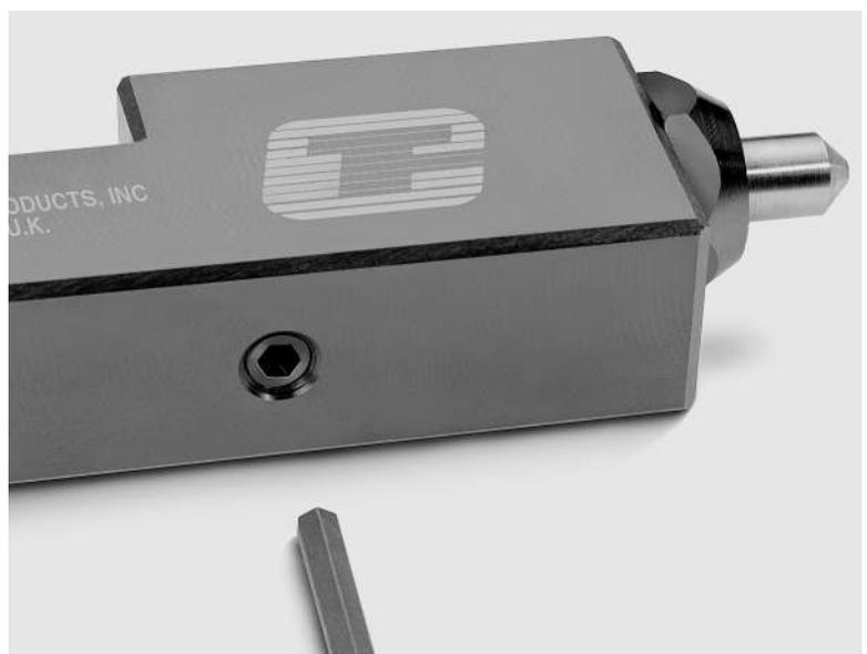
Gli utensili di rullatura con diamante possono essere regolati per ottenere la pressione di rullatura ottimale. Nei modelli DB-1 e DB-2, la vite di regolazione si trova all'estremità dell'utensile. Nei modelli DB-3 e DB-4, la vite di regolazione si trova sul fianco dell'utensile.
