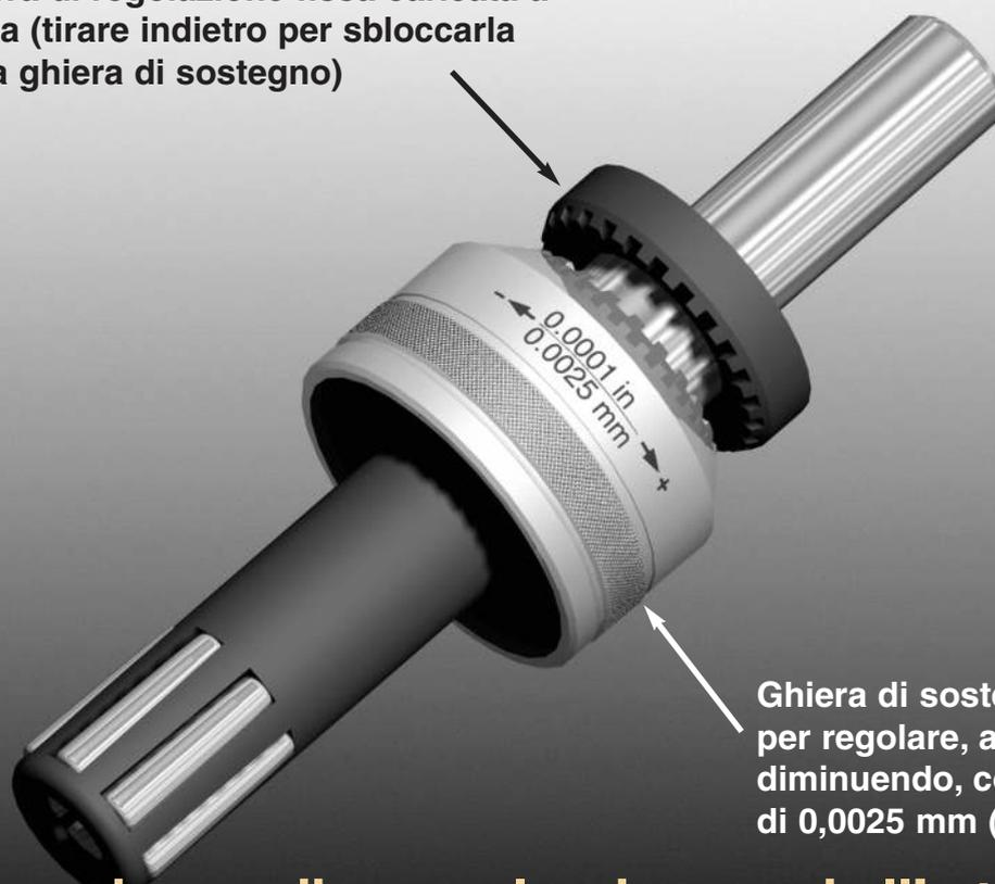
**Ghiera di sostegno (ruotare per regolare, aumentando o diminuendo, con incrementi di 0,0025 mm (0,0001")).**
