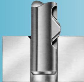
**1.** All'ingresso, la tensione della molla trattiene la lama di taglio *sostituibile e regolabile* in posizione estesa per rimuovere la bavatura sulla parte anteriore del foro.
