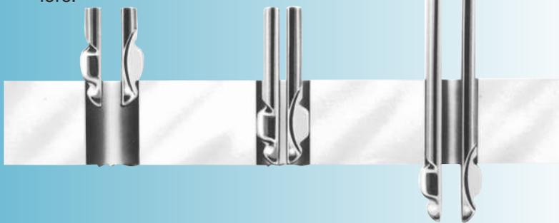
*BURR-OFF® funziona secondo lo stesso principio di base di BURRAWAY®, ma è stato progettato per operazioni di sbavatura automatizzate su grandi volumi. Il design con feritoia dell'utensile "a molletta da bucato" consente ai trucioli di uscire facilmente rendendo così l'utensile ideale per apparecchiature automatiche e macchine multimandrino.*
