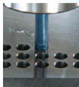
Lavorazione a secco
