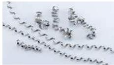
I trucioli si rompono facilmente a una velocità di taglio più elevata rispetto ai trucioli lunghi e continui delle superleghe. Ciò agevola la rimozione dei trucioli.
