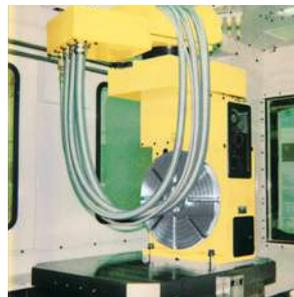
2 tavole girevoli e il box di distribuzione, sono montate su un piccolo centro di maschiatura con il cambio pallet rotante.
