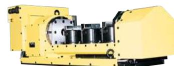
Vengono utilizzati 3 mandrini idraulici per il bloccaggio pezzi.
