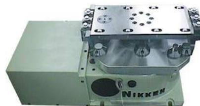
Unità di bloccaggio Pallet con accoppiatore automatico
