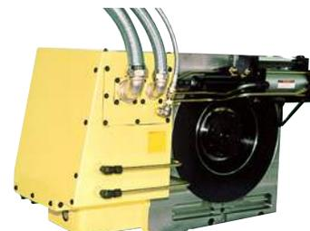
Esempio di applicazione di una mini-centralina idro-pneumatica, montata sul lato posteriore di una **CNC321**
