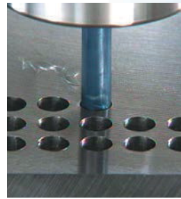
Lavorazione a secco
