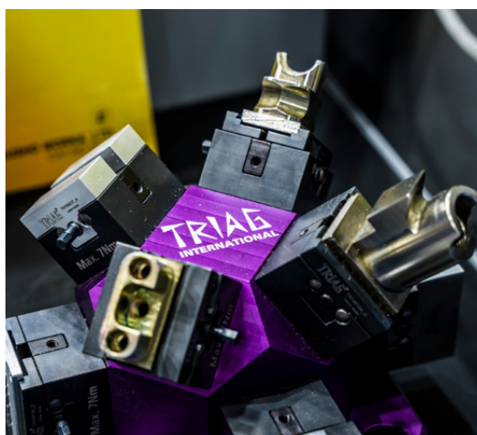
Sistema di morse TRIAG per bloccare piccoli componenti su macchine a 5 assi
