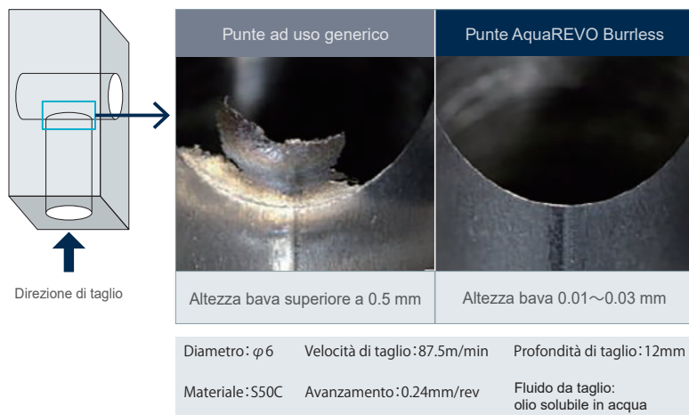
Altezza della bava (foro trasversale dello stesso diametro)
