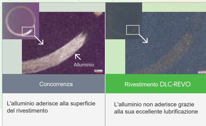
Superficie del rivestimento dopo il metodo pin-on-disk
