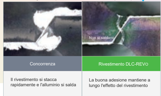
Condizioni del tagliente dopo la lavorazione dell'ADC12 (foratura)
