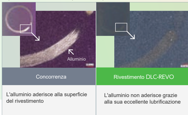
Superficie del rivestimento dopo il metodo pin-on-disk
