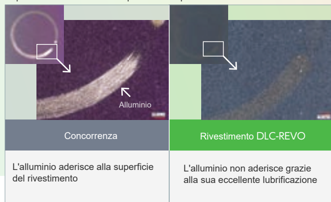
Superficie del rivestimento dopo il metodo pin-on-disk
